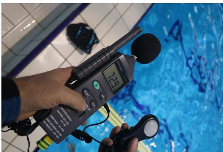
Obr. F-8 Kontrola relativní vlhkosti vzduchu v prostoru plaveckého 50 m bazénu.
