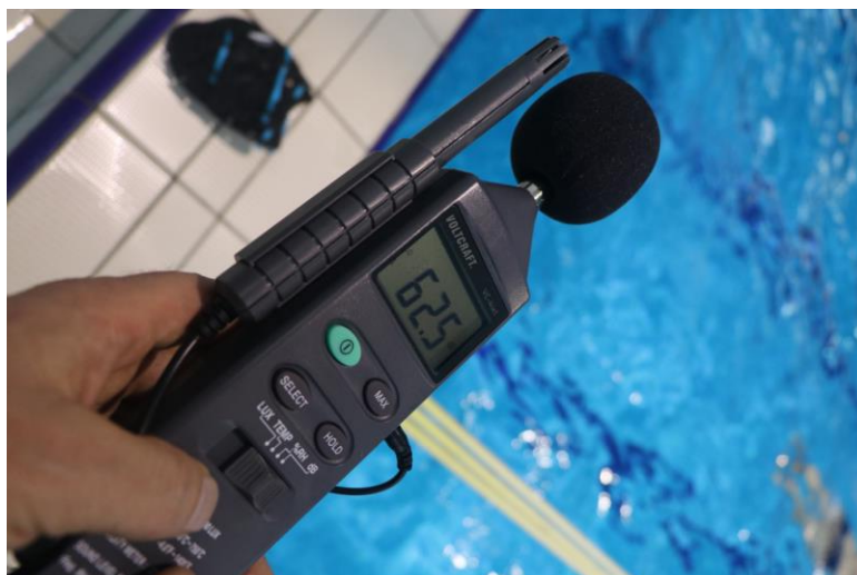
Obr. F-9 Kontrola úrovně hluku v prostoru plaveckého 50 m bazénu.
