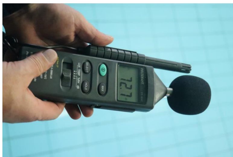
Obr. F-13 Kontrola úrovně hluku v prostoru dětského výukového bazénu.
