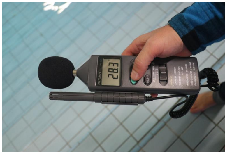
Obr. F-12 Kontrola teploty vzduchu v prostoru dětského výukového bazénu.
