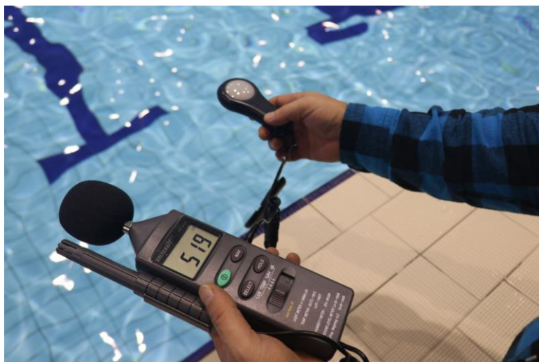
Obr. F-6 Kontrola intenzity osvětlení prostoru plaveckého 50 m bazénu.
