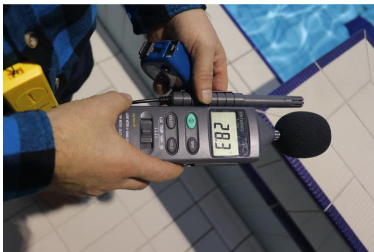
Obr. F-7 Kontrola teploty vzduchu v prostoru plaveckého 50 m bazénu.
