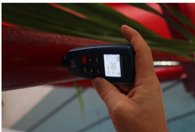
Obr. F-20 Kontrola tloušťky laku nosné konstrukce tobogánu ve vnitřních prostorech plaveckého 50m bazénu.
